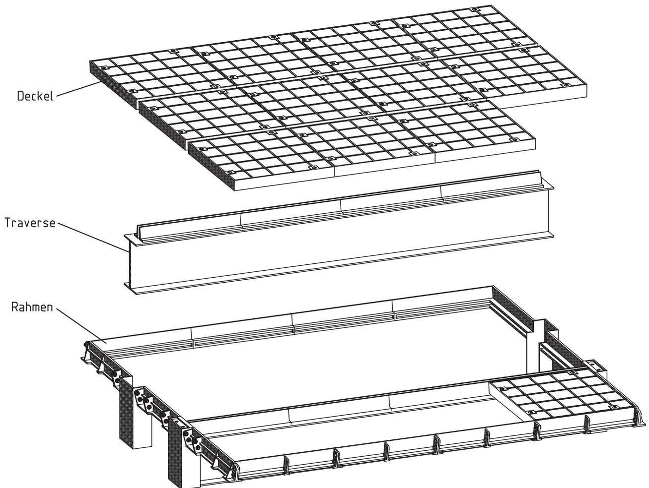
Alle Schachtabdeckungen müssen fest, mit einem gleichmäßigen Auflager eingebaut werden, um den jeweiligen Verkehrsbelastungen dauerhaft standhalten zu können. Aufgrund der sehr unterschiedlichen Einbausituationen ist es schwierig für jeden Einzelfall eine präzise Einbauanweisung zu erstellen. Die folgenden Rahmenbedingungen sollten jedoch beim Einbau beachtet werden.
