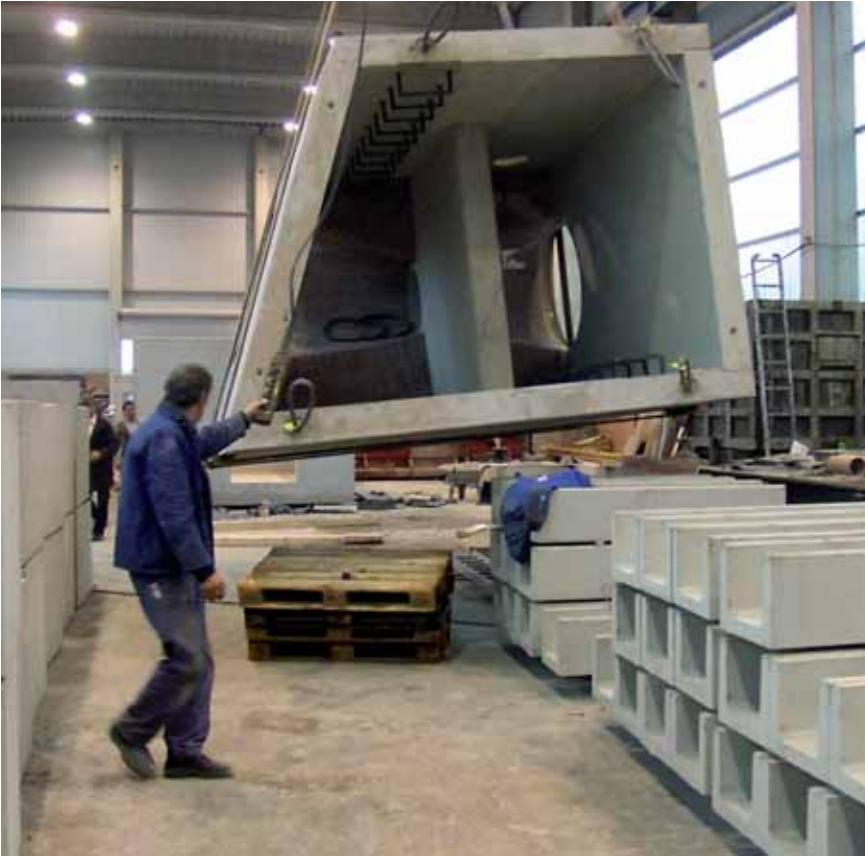
Hildesheim Regenüberlaufbauwerk einteilig schiefwinkelig mit Trennwand, Schieber, Gerinne geklinkert lichte Innenmaße l/b/h 215-290/210/395 cm
